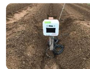
圃場に設置された 土壌水分計端末
