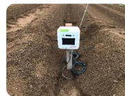
圃場に設置された 土壌水分計端末
